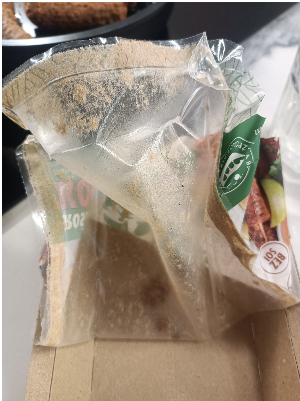
Obraz 6. Tacka kartonowa powleczona polimerem z przygrzaną folią wierzchnią Źródło: Opracowanie własne
